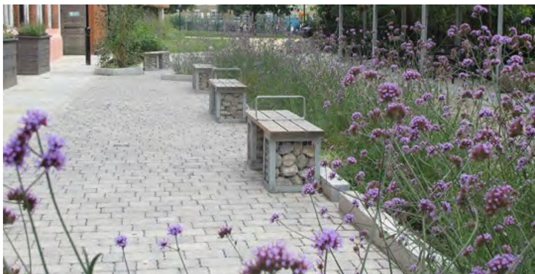
005 irudia: Derbyshire Street Pocket Park. Londres. Azalera iragazkorrek eta landarediak hiriko eremu horretan uholde-arriskua murrizten laguntzen dute, eta ingurune bizigarriagoa sortzen dute tokiko komunitatearentzat.
